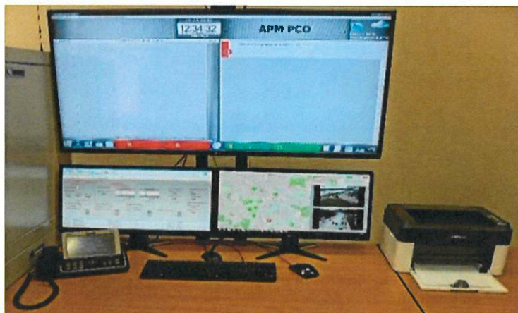
Рисунок А.7.1 – АРМ региональной системы оповещения
