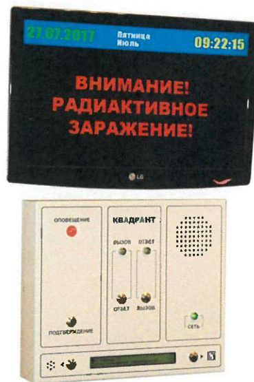
Рисунок А.4.3 – Комплекс локального оповещения ИТК ОС ЛО
